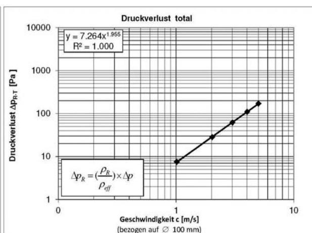
Ø 100 mm mit Luftmengenregulierung (Stufe 3; maximal geöffnet)
